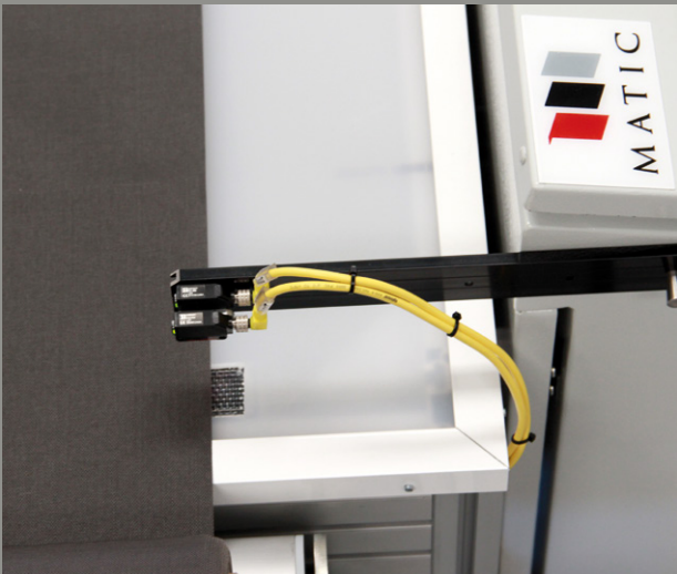
Photocells to line up the textile / Fotocélulas de alineación del tejido
